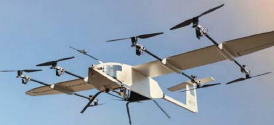
Teile des städtischen Verkehrs in die Luft zu verlagern, ist längst kein Zukunftstraum mehr. Innerhalb des Fraunhofer-Leitprojekts ALBACOPTER® soll eine fliegende Experimentalplattform mit der Vertical Take-Off and Landing Fähigkeit eines Multicopters und den aerodynamischen Vorzügen eines Gleiters entwickelt und für Test- und Demonstrationsflüge zugelassen werden.
